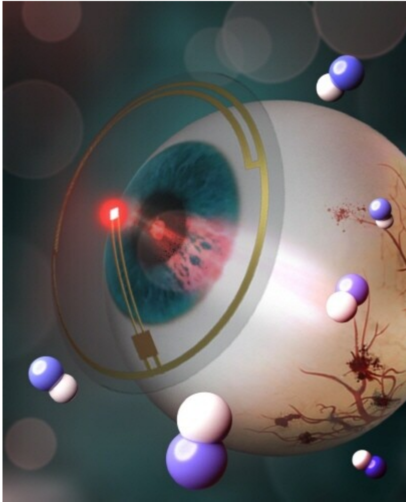
▲ LED가 장착된 무선구동 스마트 콘택트렌즈를 이용한 당뇨성 망막병증 예방·조기 치료 시스템에 대한 모식도 (사진=POSTECH 제공)
