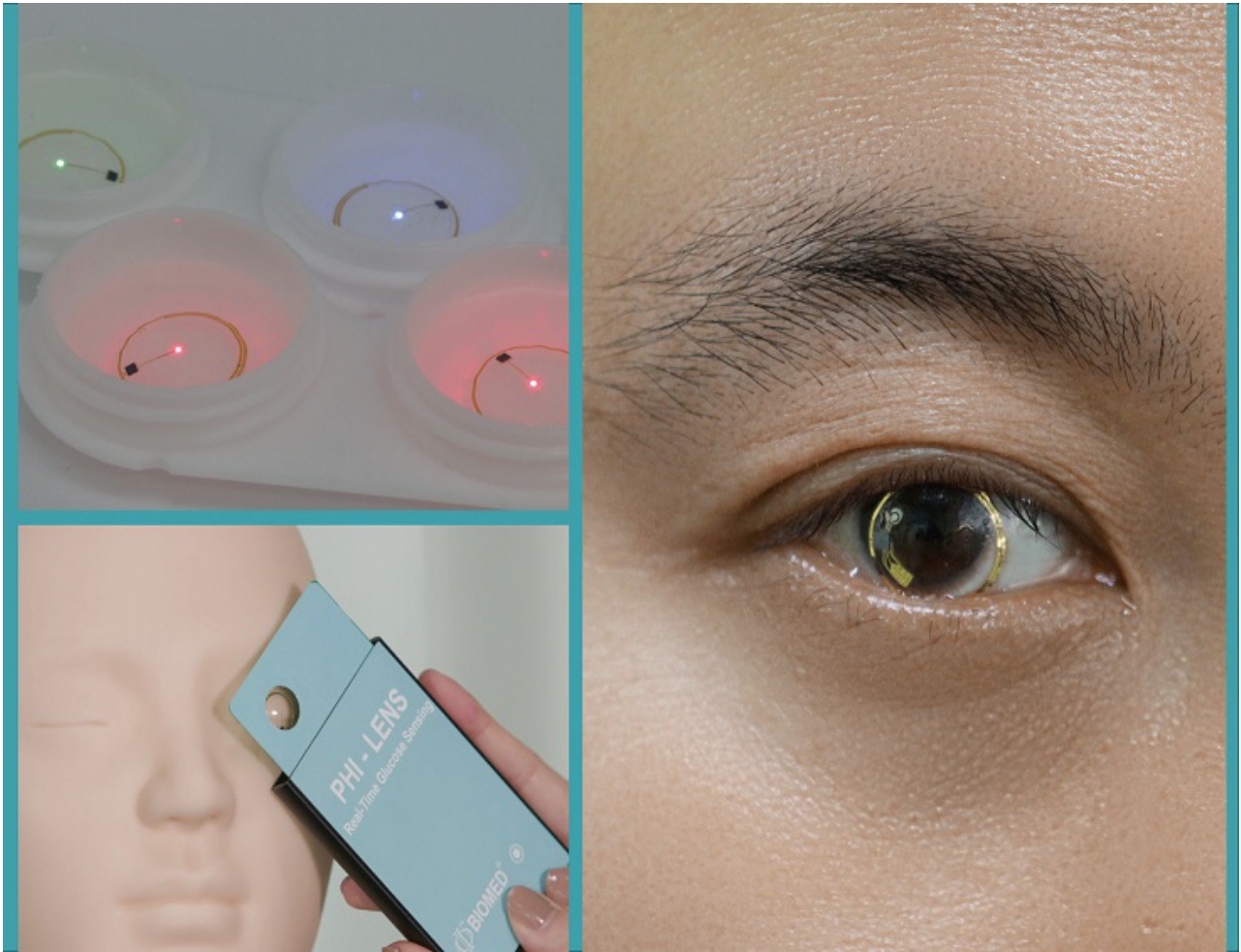
연구자 임상시험에서 착용한 무선 구동 스마트 콘택트렌즈와 당뇨 진단 결과가 스마트폰으로 전송되는 영상의 캡처 사진
