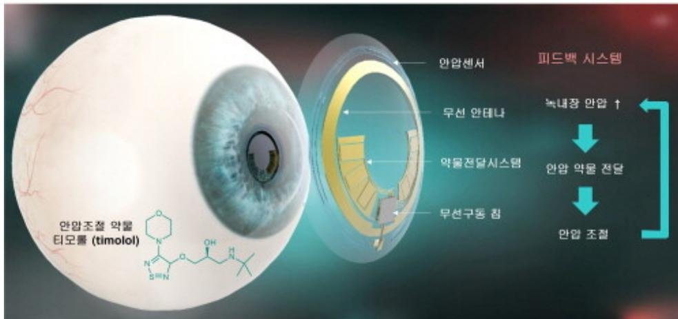
▲ 녹내장 환자의 안압 모니터링 및 안압 조절 약물 전달 피드백 시스템에 대한 모식도 (사진=POSTECH 제공)
